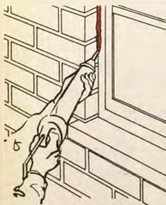
8. ábra Kettős ütközésű ablakoknál a tömítést a belső ütközőfelületre helyezzük
