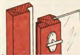
9. ábra Egyszeres ütközésű ablaknál a tömítést általában a szárnyra tesszük
