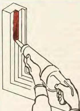
7. ábra Tömítőíttek alkalmasak az ablakok hézagainak tömítésére
