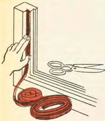
6. ábra Ablak tömítése rugalmas öntapadós tömítőszalaggal
